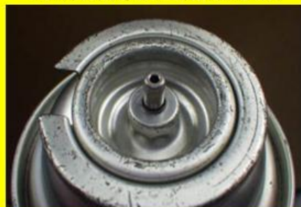
ボンベ先端部分にサビが出ているもの
