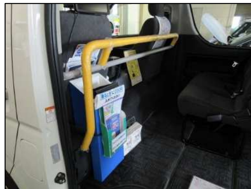
▲参考）車内手すり設置写真
