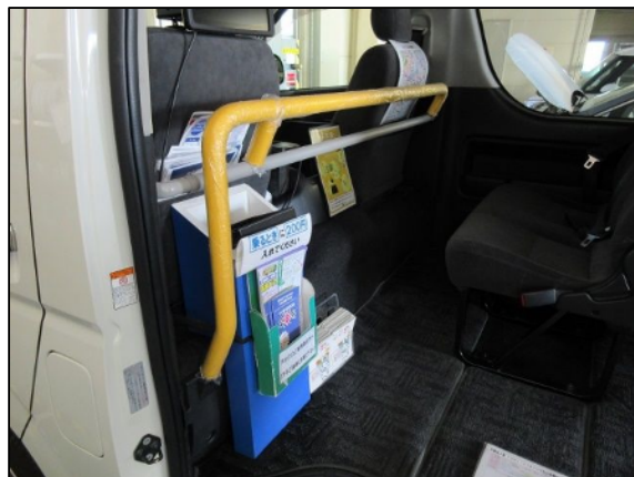
▲車内手すり設置写真
